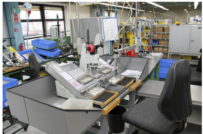
Moderne One-Piece-Workflow-Arbeitsplätze erzielen Wirkungen in mehreren Handlungsfeldern – hier profitieren die Mitarbeiter und das Unternehmen gemeinsam (Foto: HARTING).
